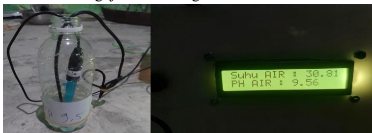
Gambar 11. Pengujian dengan Alat Nilai Ph 9,5 dan Suhu 30 0 C
