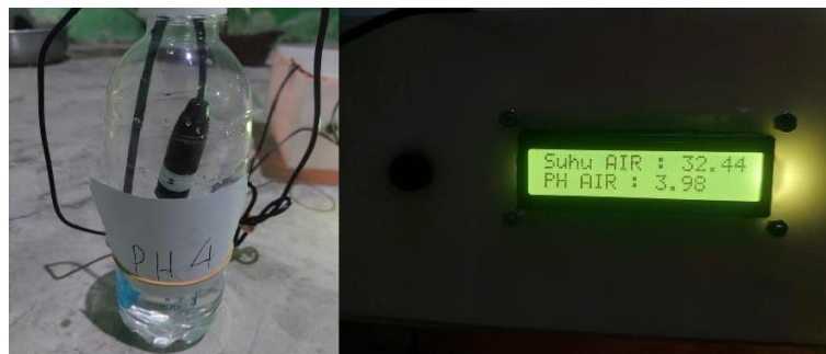
Gambar 9. Pengujian Alat dengan Nilai Ph 4 dan Suhu 32 0 C
