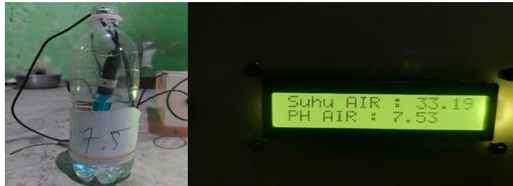
Gambar 10. Pengujian Alat dengan Nilai Ph 7.5 dan Suhu 33 0 C
