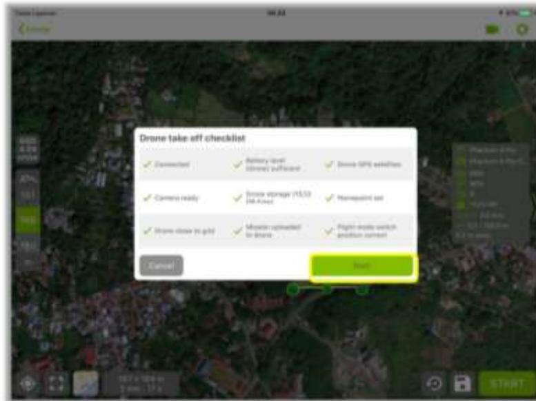
Gambar 9. Tampilan *Drone take off checklist* yang telah dichecklist seluruhnya
