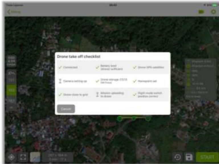
Gambar 8. Tampilan *Drone take off checklist* pada Pix4D Capture
